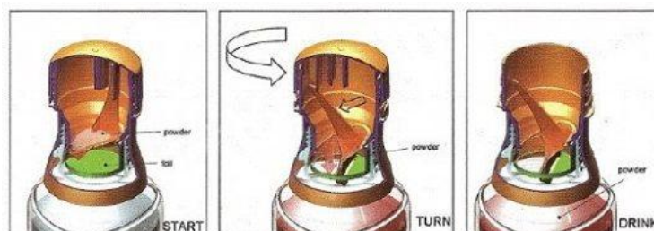
Figura 3.3 – Esquema representativo do funcionamento da cápsula dispensadora da bebida Cedevita (Steeman, A., 2012).
