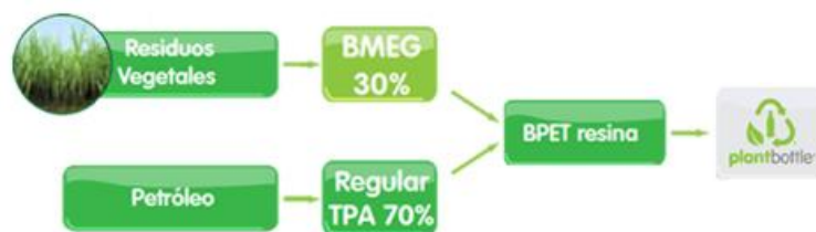
Figura 4.3 – Fabrico da Plantbottle da Coca-Cola (s.n., The Coca-Cola Company, s.d.).
