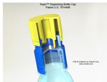
Figura 3.6 - Cápsula dispensadora Aspin (Steeman, A.,2013).
