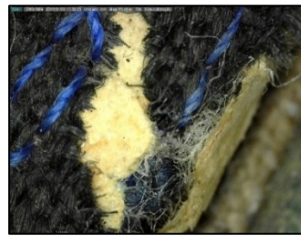
Figura 38 - Depois da fixação da espuma de preenchimento e do papel com ampliação microscópica de '50x (©Diana Tavares);
