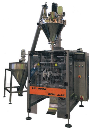
Figura ii- Equipamento formador de sacos (tipo kg) e embla produtos moídos.
