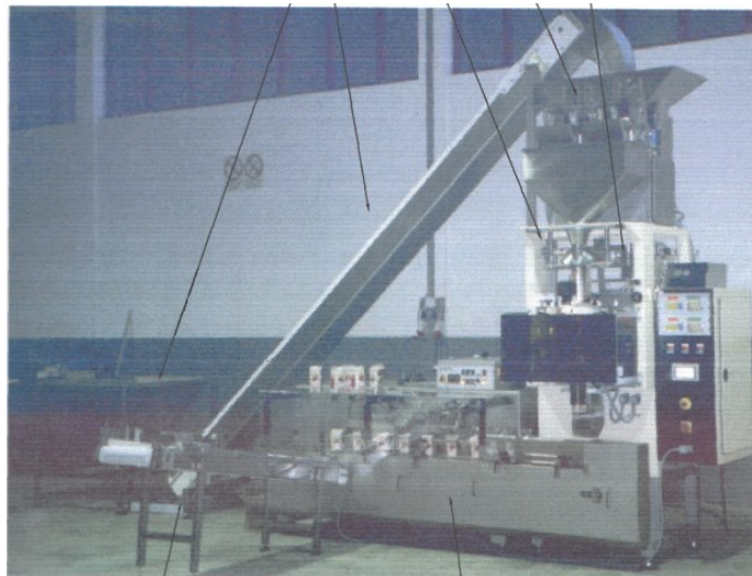
Figura iii- Equipamento formador de sacos (tipo kg) e embla produtos granulados.
