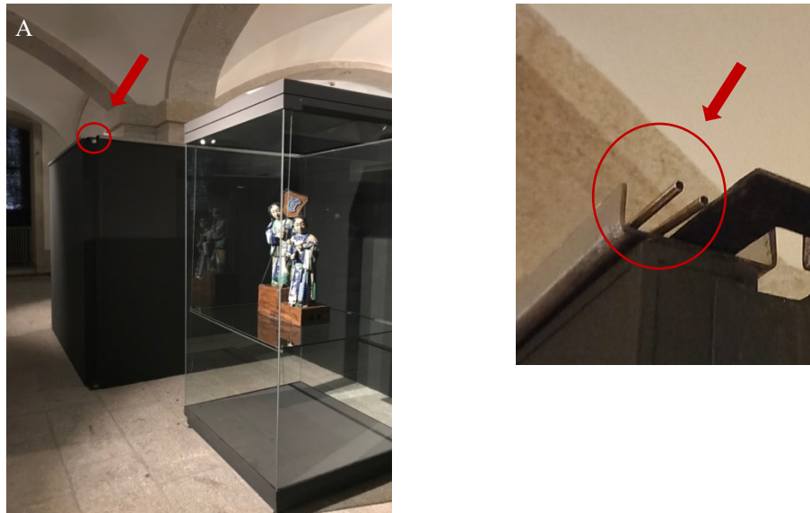
Figura 30 (A) Vista parcial da sala das pedras, térreo, MNSR; (B) Localização dos dispositivos Tenax ® TA e data logger de temperatura e HR ao topo de uma divisória
