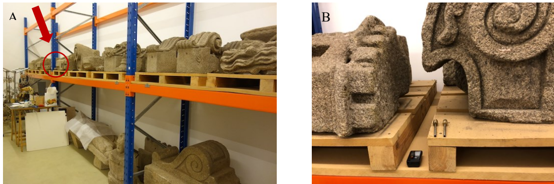
Figura 29 Reserva de lapidária do MNSR, com indicação do local onde os dispositivos foram posicionados; (B) Detalhe dos dispositivos Tenax ® TA e data logger de temperatura e HR
