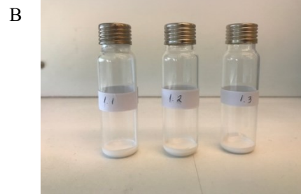
Figura 19 Amostras de materiais de construção de exposição temporária antes e após serem pesadas e inseridas em vials. (A) Tinta plástica Robbialac Stucomat Ultra-mate branca; (B) Vials com tinta; (C) Aglomerado; (D) Vials com aglomerado; (E) Aglomerado pintado (revestimento aplicado há mais de 6 meses); (F) Vials com aglomerado pintado; (G) MDF; (H) Vials com MDF.
