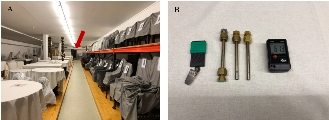
Figura 28 (A) Reserva técnica de mobiliário do MNSR, com indicação do local onde os dispositivos foram posicionados; (B) Detalhe dos dispositivos da esquerda para a direita: SKC 500, Tenax ® TA e data logger de temperatura e HR
