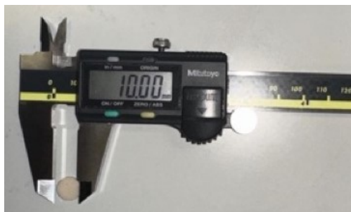
Figura 13 – Paquímetro digital utilizado para verificar a dimensão dos provetes.
