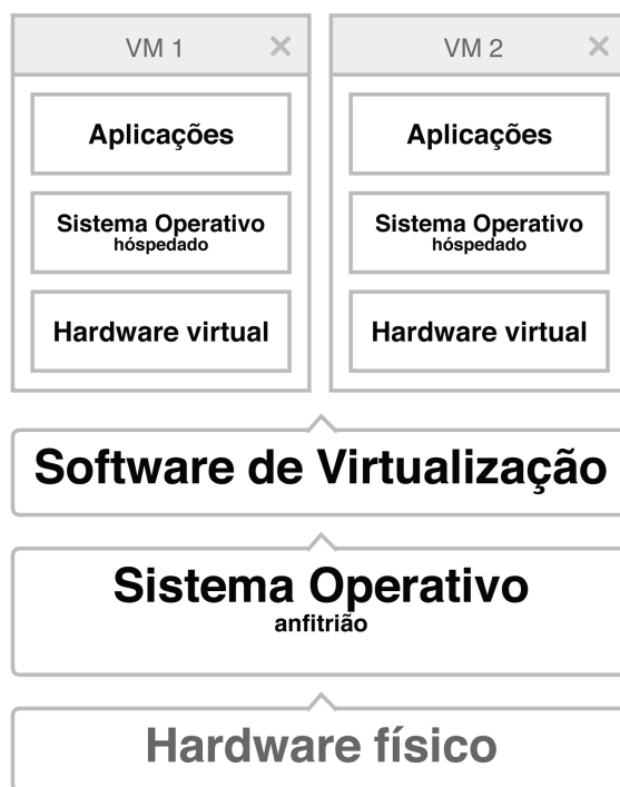
Figura 7 – Diagrama conceptual de um VMM do tipo 2
