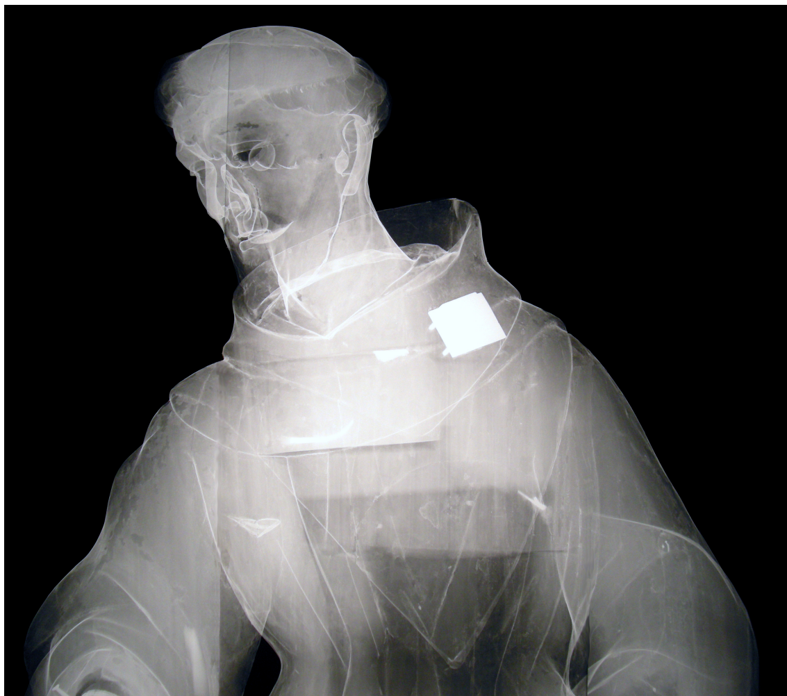
Fig.37 – Pormenor da cabeça (radiografia frontal). Na cabeça são visíveis os olhos de vidro, sendo que um se encontra na cavidade ocular e o outro está atrás da boca. A zona mais escura no peito diz respeito ao local onde a obra é oca e o elemento mais claro diz respeito à chapa metálica que se encontra no reverso.
