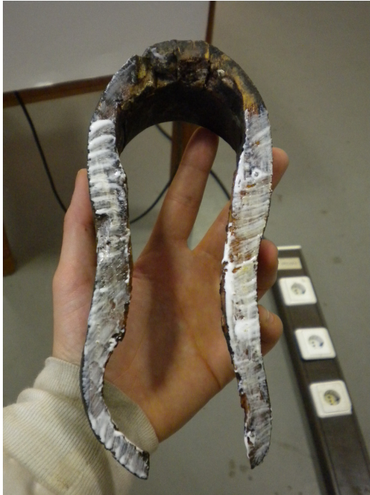
Fig.112 – Pormenor da aplicação de PVA no pedaço destacado
