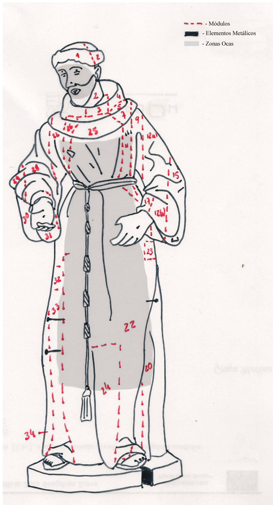
Fig.40 – Esquema inicial do método de construção visto de frente
