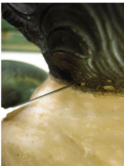
Fig.147 – Pormenor da aplicação do Etanol e da Água quente
