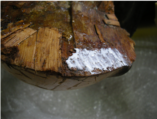
Fig.160 – Pormenor da remoção dos vestígios do adesivo original, utilizando-se PVA
