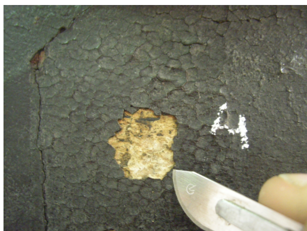
Fig.69 - Pormenor da recolha da amostra das vestes, removida no peito
