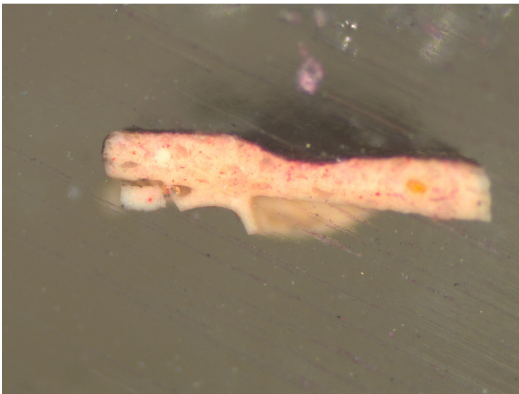
Fig.86 – Amostra recolhida da carnação da mão, tingida com Fuchshina Ácida
