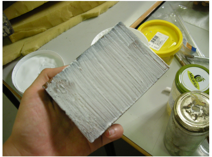
Fig.117 - Pormenor da aplicação de PVA no elemento que se destacou
