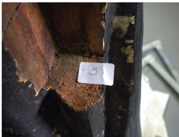
Fig.65 – Pormenor do local onde o elemento se destacou e de onde foi retirada amostra do corte transversal
