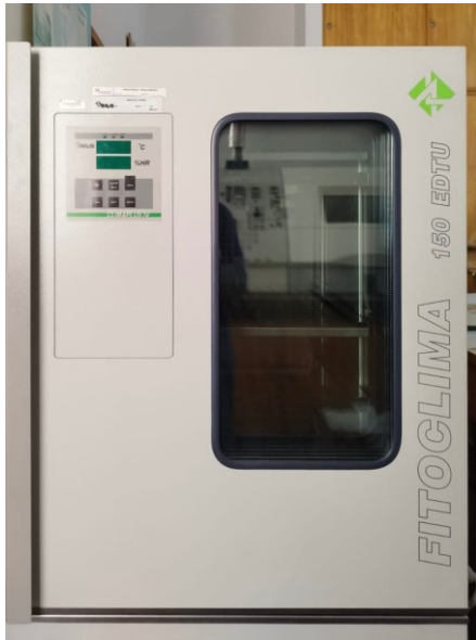
Figura 11 Fitoclia 150 EDTU: Equipamento utilizado para o Envelhecimento Acelerado.
