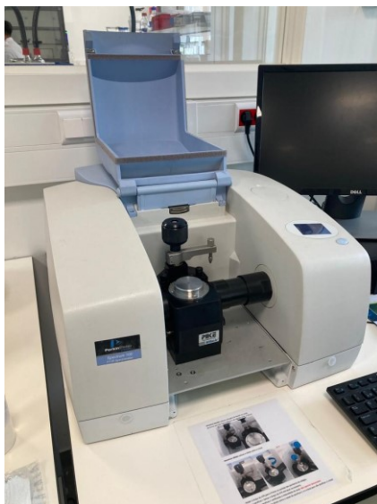
Figura 23 Spectrum 100 FTIR: Equipamento utilizado para a espectroscopia de infravermelho com transformada de Fourier.
