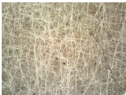
Figura 26 Fotografia tirada com o Dino-Lite Digital Microscope. Pormenor da amostra em papel de filtro com Tylose® (PF4) em que se pode observar uma fissura.
