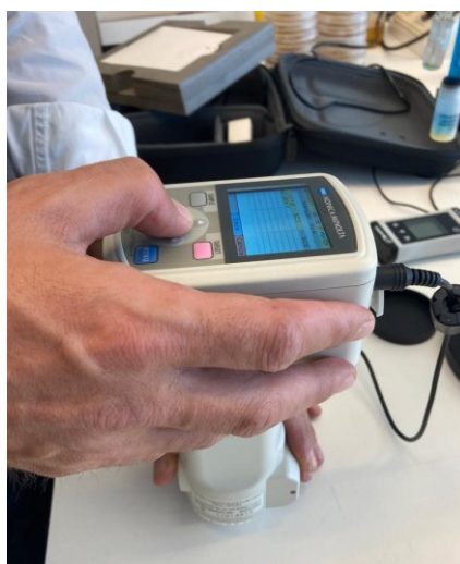
Figura 22 Spectro Photo meter CM-700d: Equipamento utilizado para as medições de colorimetria.
