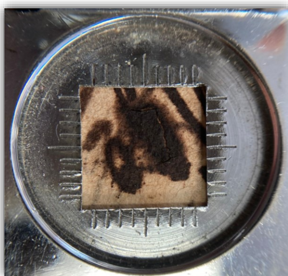
Figura 2 Pormenor em que se observa a corrosão da tinta, escurecimento, auréolas ao redor da mesma e fissura (quebra do suporte).
