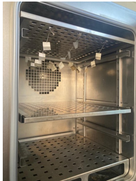
Figura 10 Durante o processo de envelhecimento as amostras foram divididas por três filas e suspensas por um fio de algodão e seguras por nós.
