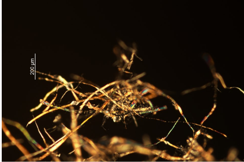
Figura 32 Identificação das fibras de linho por microscópio ótico utilizando luz transmitida polarizada cruzada.
