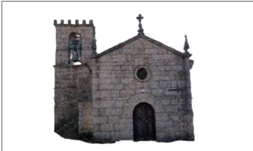
Figura 24: Alçado oeste obtido com as imagens fotogramétricas, onde se utilizou o Photoshop para limpar a poluição visual do seu contorno. Créditos: João Sandes, 2020
