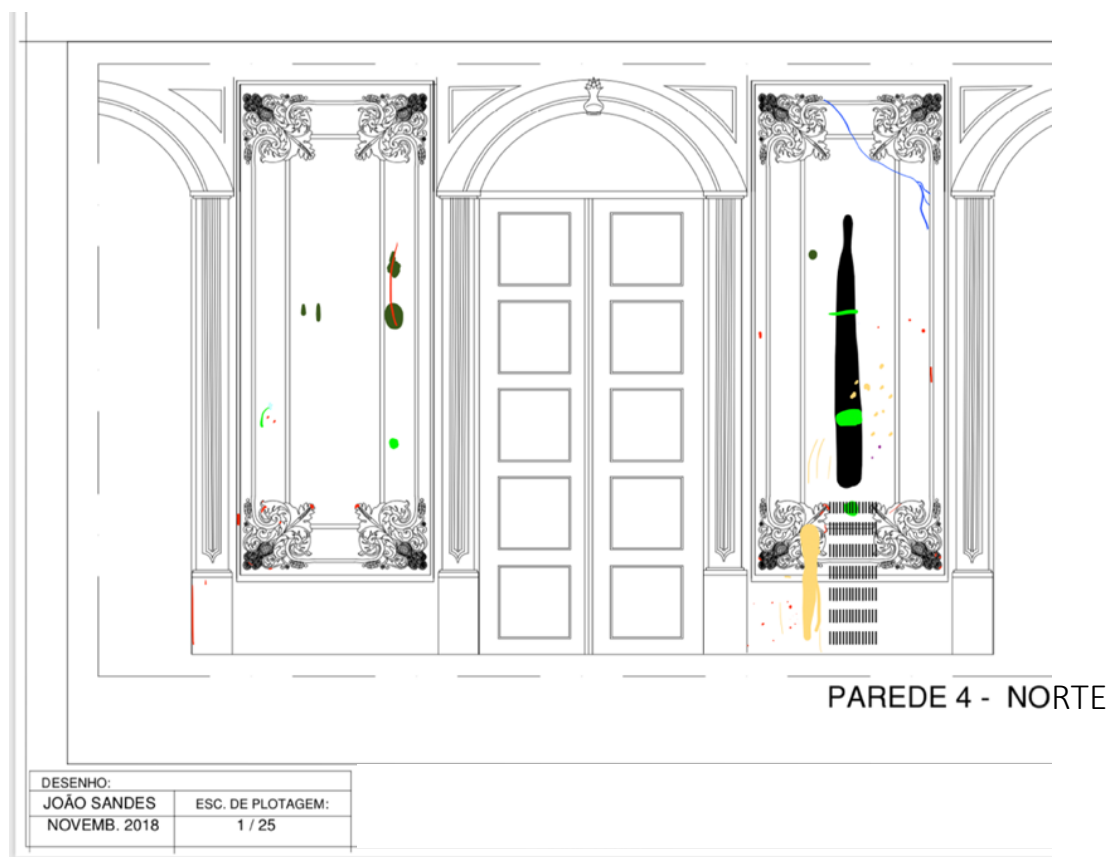
Mapa de danos 4- Parede IV. (Identificação das anomalias por Inês Magalhães ©)
