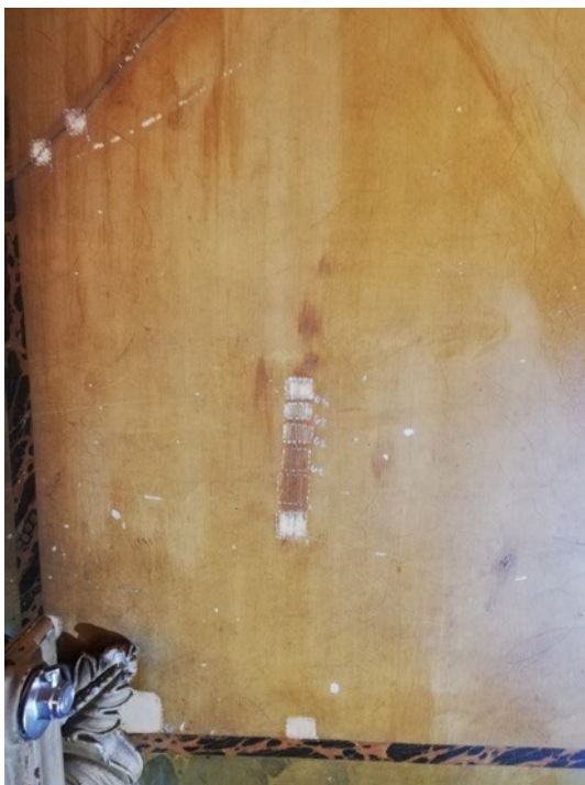
Figura 83- Testes de solubilidade Parede I. (Inês Magalhães ©)
