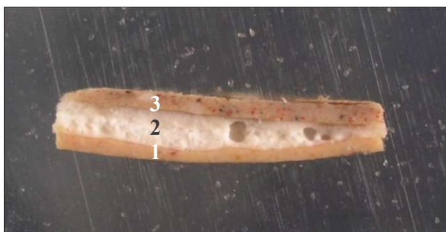
Figura 22 - Corte estratigráfico da carnação. ©MiguelRamos
