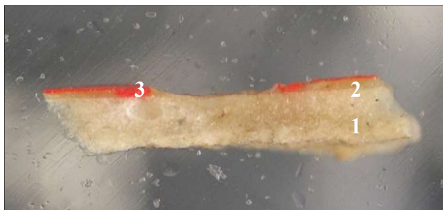
Figura 21 - Corte estratigráfico da policromia vermelha. ©MiguelRamos
