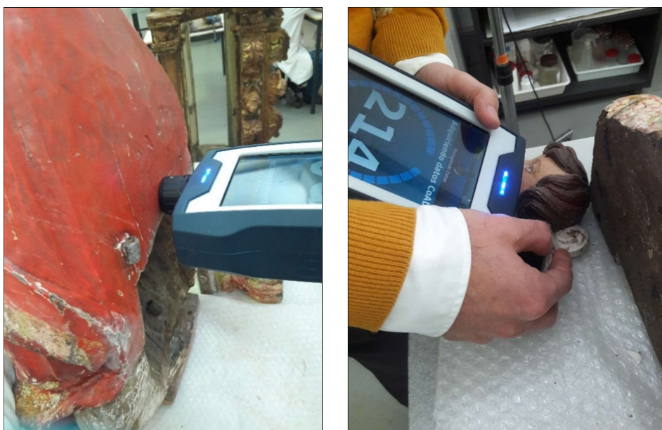
Figura 70 e 71 - Análise Raman realizadas pelo BRAVO handheld Raman Spectrometer®. ©CatarinaNeto
