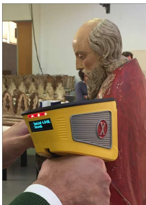
Figura 78 - Análise EDXRF realizadas pelo espectrómetro portátil SciAps® X-200. ©CatarinaNeto
