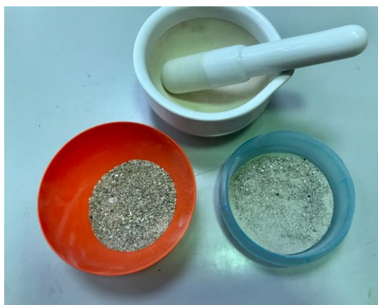
Figura 179-Figura 181. Trituração dos agregados originais de pedra com um almofariz e pilão para a sua incorporação na argamassa para a reintegração volumétrica e tonalização (©Carlota Carvalho)
