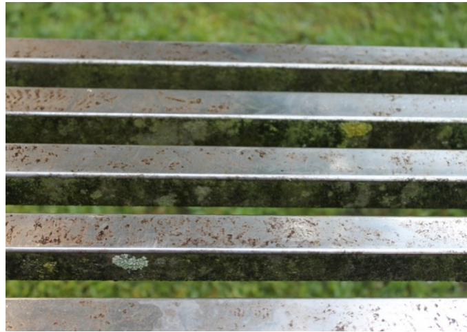
Figura 3. Colonização Microbiológica na Superfície Metálica (Zona do Assento do Banco) (©Carlota Carvalho)
