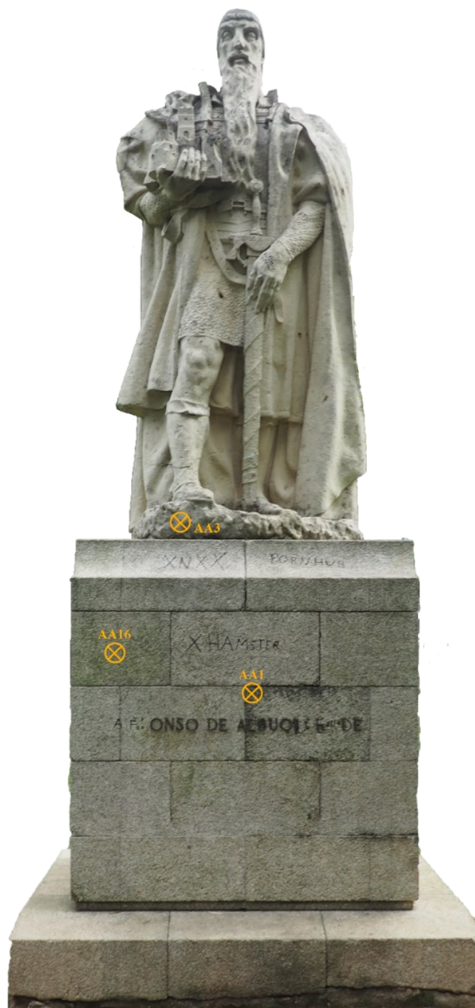
Figura 40. Plano das áreas de amostragem da vista frontal para a metodologia de Karsten Pipes da escultura Afonso de Albuquerque (© Carlota Carvalho)
