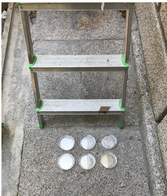
Figura 56. Placas de Petri ponto B para a avaliação da qualidade microbiológica do ar no Pavilhão de Escultura e Pintura (©Carlota Carvalho)
