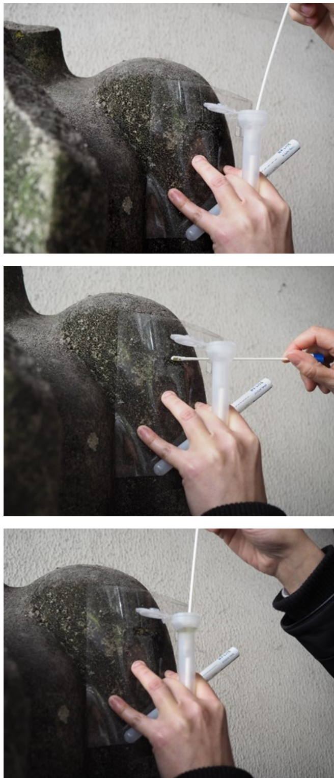
Figura 7- Figura 9. Recolha de amostras para a quantificação de ATP por Bioluminescência utilizando as canetas de ATP HY-LiTE® Fuel Test Kit Pens (©Carlota Carvalho)
