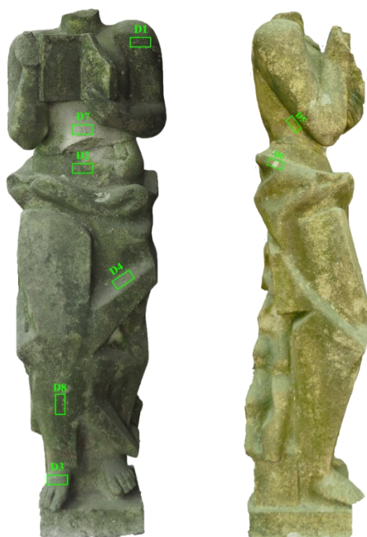
Figura 18 e Figura 19. plano das áreas de amostragem da vista frontal e da vista lateral esquerda para a determinação da concentração de ATP por Bioluminescência no esboço da escultura Doutrina
