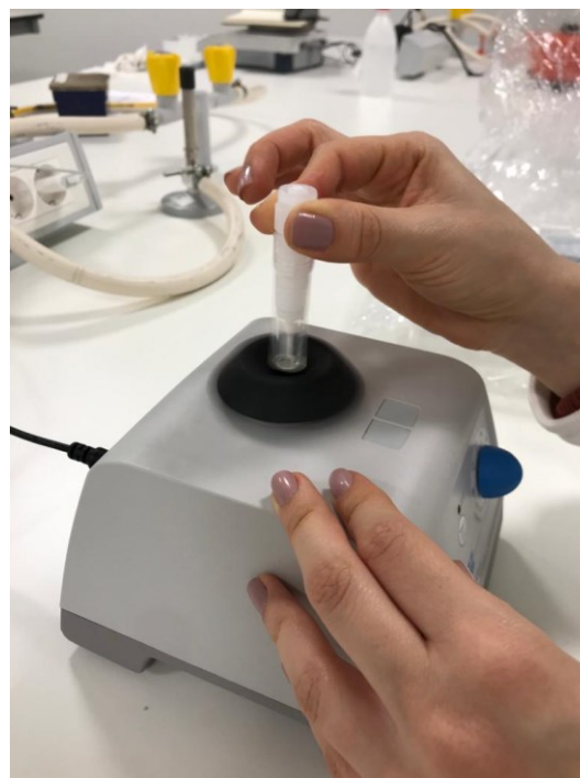
Figura 14 e Figura 15. Preparação das canetas de ATP HY-LiTE® Fuel Test Kit Pens para a medição do ATP com recurso ao HY-Lite® 2 Luminometer (©Carlota Carvalho)
