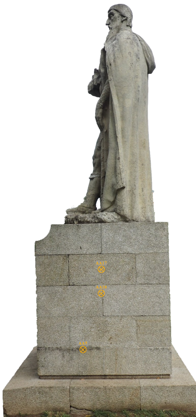
Figura 41. Plano das áreas de amostragem da vista lateral direita para a metodologia de Karsten Pipes da escultura Afonso de Albuquerque (© Carlota Carvalho)
