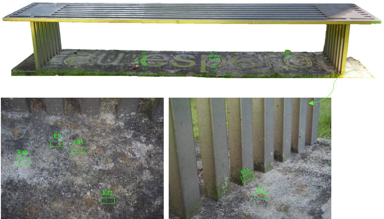
Figura 21. Plano das áreas de amostragem determinação da concentração de ATP por Bioluminescência da escultura Eu Espero
