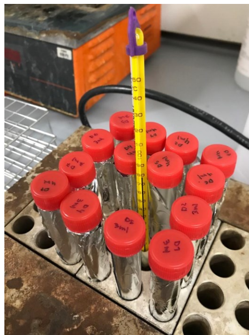
Figura 28 e Figura 29. Tubos com as amostras e DMSO na placa de aquecimento a 65°C (©Carlota Carvalho)
