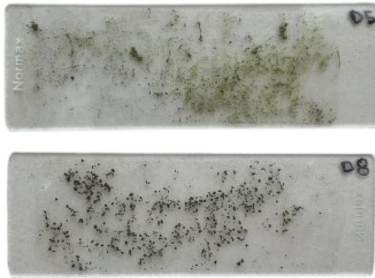
Figura 3 e Figura 4. Lâminas com a fita adesiva microbiológica após a amostragem (© Carlota Carvalho)
