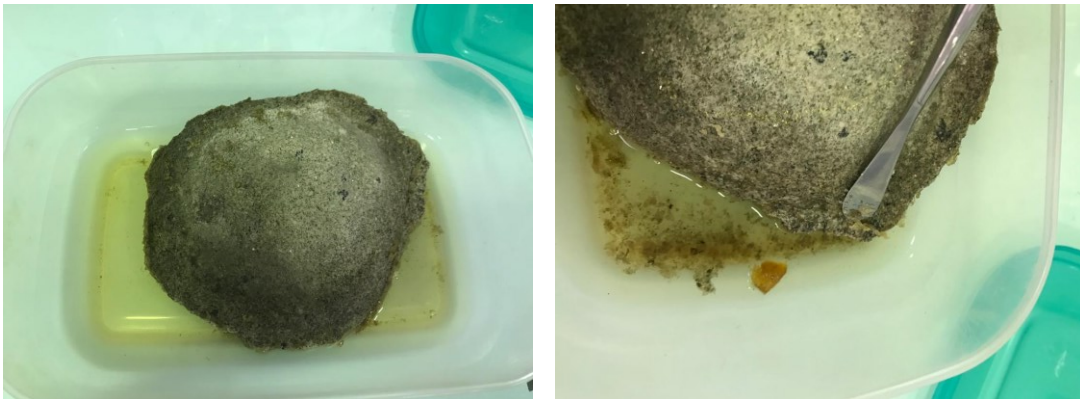
Figura 143 e Figura 144. Recipiente com acetona para a remoção da resina e auxílio com uma espátula metálica semirrígida (©Carlota Carvalho)
