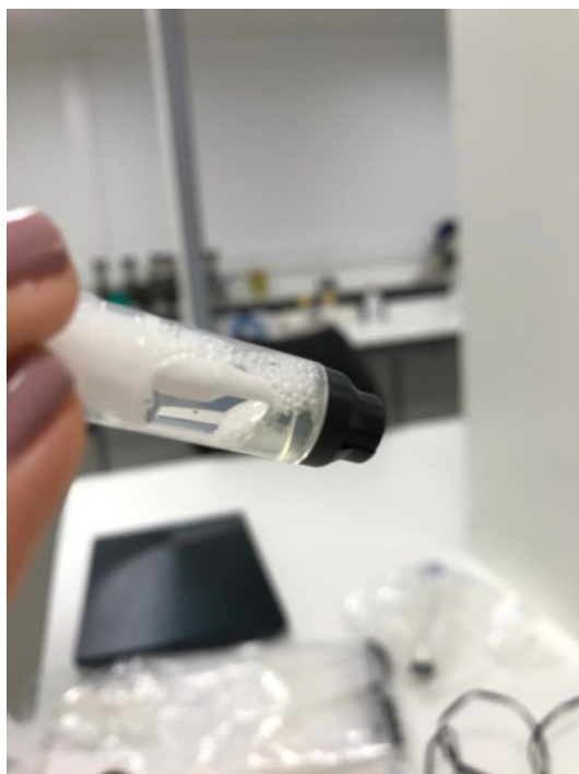
Figura 14 e Figura 15. Preparação das canetas de ATP HY-LiTE® Fuel Test Kit Pens para a medição do ATP com recurso ao HY-Lite® 2 Luminometer (©Carlota Carvalho)
