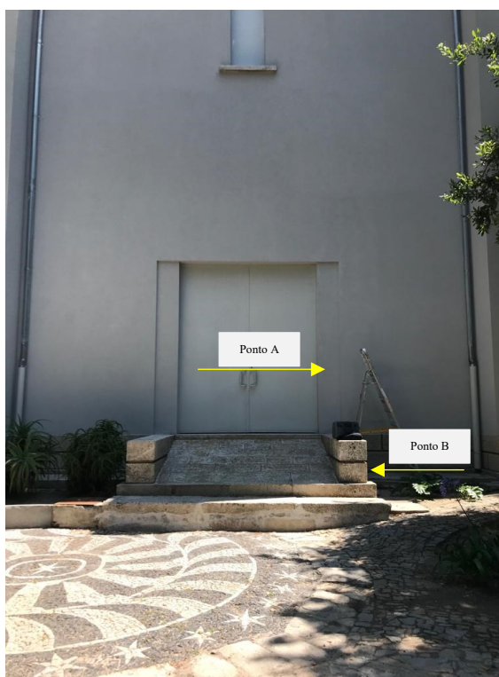
Figura 54. Pontos para o posicionamento das placas de Petri para a avaliação da qualidade microbiológica do ar no Pavilhão de Escultura e Pintura (©Carlota Carvalho)
