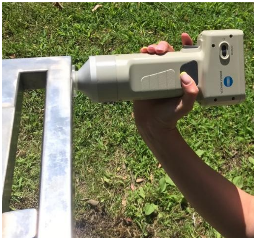
Figura 1. Uso do colorímetro Konica Minolta Chroma Meter CR-400 para as leituras na escultura Eu Espero (©Vitória Couto)
