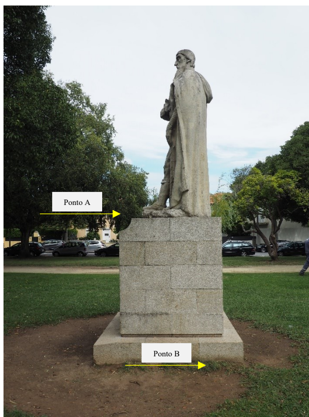
Figura 50. Pontos para o posicionamento das placas de Petri para a avaliação da qualidade microbiológica do ar na escultura Afonso de Albuquerque (©Carlota Carvalho)
