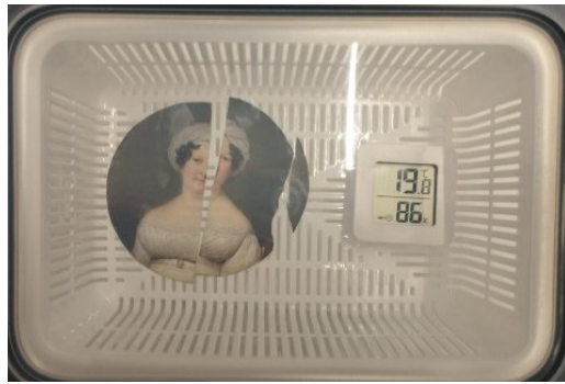
Figura 58 Câmara de humificação com a miniatura e termo higrómetro
