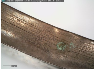
Figura 37 Cloretos de cobre no aro de cobre. Ampliação de 64.8 X com microscópio digital Dino-Lite® AM4113T
