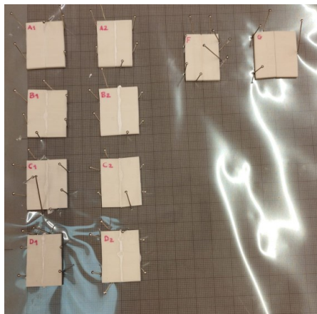
Figura 78 Sistema de secagem após a aplicação do adesivo. Captada pela própria
