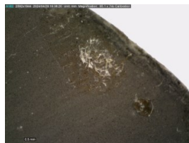
Figura 34 Resíduos de adesivo sobre a camada cromática. Ampliação de 64.8 X com microscópio digital Dino-Lite® AM4113T
