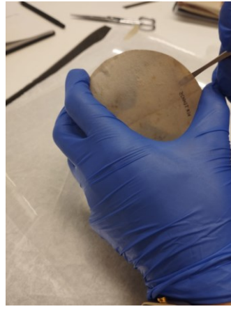
Figura 52 Remoção do cartão de backing após emulsão do adesivo
