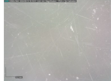
Figura 39 Microfissuras e redes de estalados no vidro. Ampliação de 64.8 X com microscópio digital Dino-Lite® AM4113T
