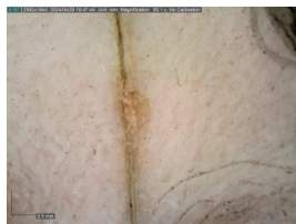
Figura 33 Resíduos de adesivo na zona de fratura Ampliação de 64.8 X com microscópio digital Dino-Lite® AM4113T
