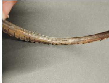
Figura 38 Sujidade e deformação do aro de latão. Ampliação de 64.8 X com microscópio digital Dino-Lite® AM4113T
