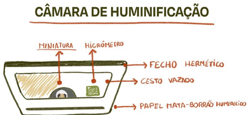
Figura 57 Ilustração do sistema da câmara de humidificação e os seus componentes. Ilustrado por Ana Coelho
