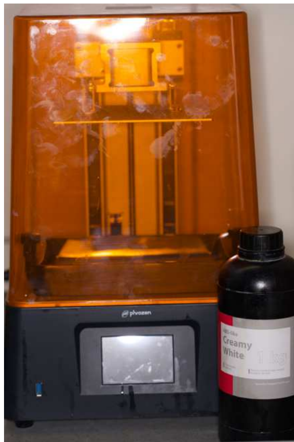
Figura 6 – Impressora 3D e material resinoso usados na impressão das guias cirúrgicas.
