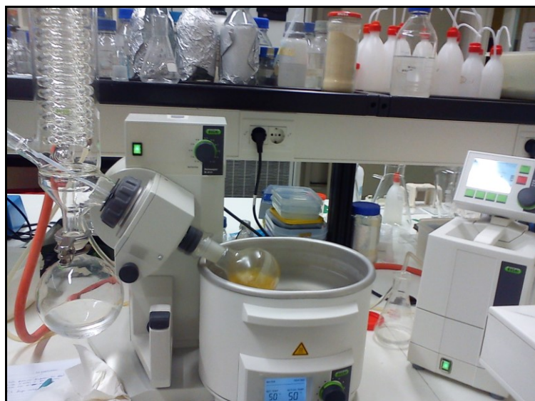
Figura 3.4 Evaporação no rotavapor do solvente de hexano em solução com a biomassa de P.cruentum .
