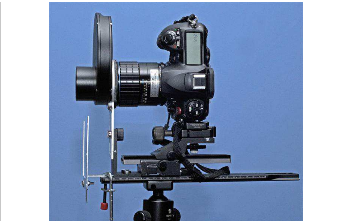
Figura 47: Objetiva Coastal Optics 60mm f/4 UV-VIS-IR Apo Macro. A objetiva encontra-se aplicada numa reflex digital Fuji ISPRO (com sensibilidade espectral UV e IV). À frente da lente aplicou-se uma roda de filtros óticos. Fotografia por LBP.
