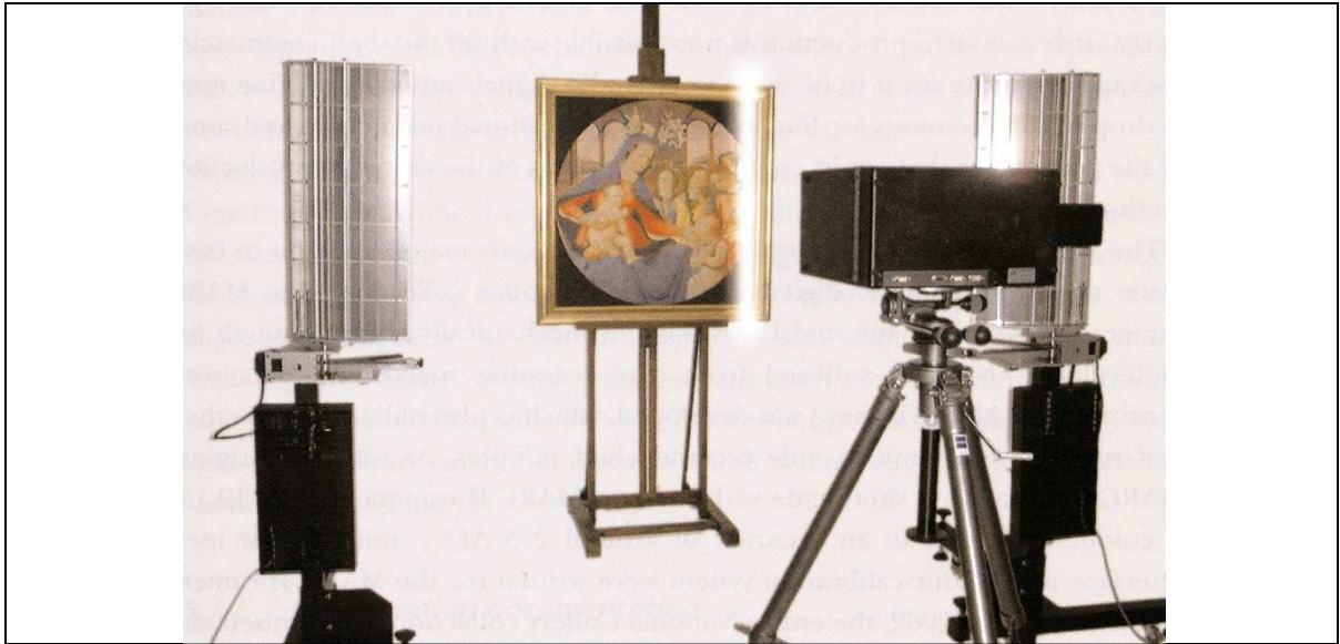
Figura 38: exemplar de uma câmara de alta resolução multiespectral CRISATEL. Durante a aquisição de uma pintura, câmara em 1.º plano, conjuntamente com o sistema de iluminação Jumbolux. Fonte: Saunders, et al. (2006, p. 539).
