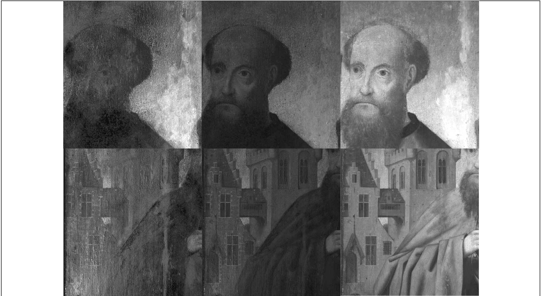
Figura 79: Dois pormenores em imagens monocromáticas de três bandas espectrais - zona Z5 do “Tríptico de Miragaia”.
