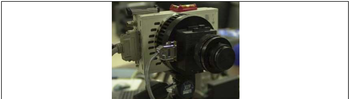
Figura 36: Sistema hiperespectral com câmara digital CCD Quantix, com filtro sintonizável e objetiva. Sistema designado no texto como Sistema III. Fonte: Day (2003a).
