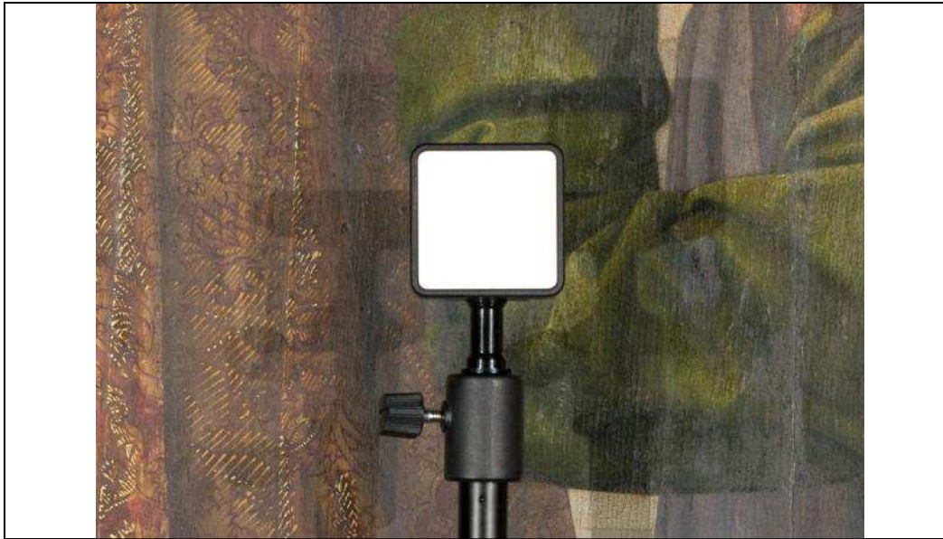
Figura 57: Alvo branco de referência, da Labsphere, modelo de ref. a SRT-99-020. Fotografia por LBP.
