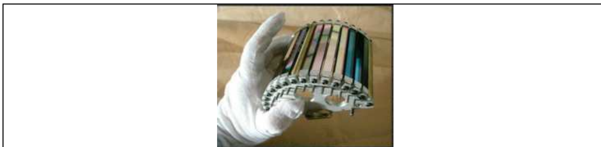
Figura 39: sistema de filtros dicróicos usados na versão JumboScan do sistema CRISATEL. Os 13 filtros são lineares, uma vez que o detetor é um CCD monolinear. Fonte: Lumiere Technology (2004).
