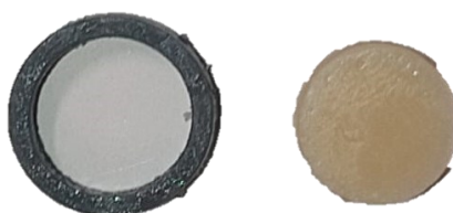
Figura 7: Modelo de resina e disco de ionómero de vidro. Ø interno do modelo de 8mm e 2mm de altura. Ø disco de 8mm e 2mm de altura.
