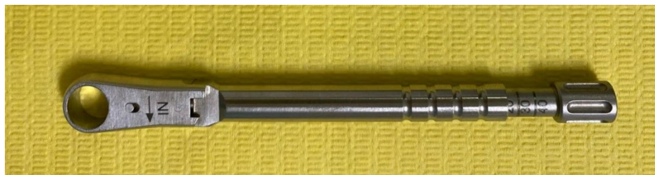
Figura 1 - Torquímetro do tipo toggle-style , da marca Medentika ®
