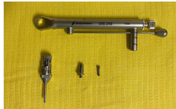
Figura 5 - Torquímetro spring-style , parafuso protético, pilar reto ( Straumann ® ) e chave de aperto
