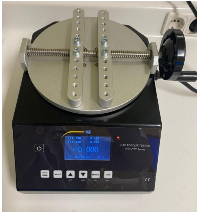
Figura 6 - Torquímetro de bancada da PCE Instruments™, modelo PCE-CTT 2
