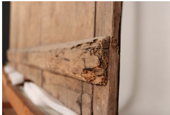
Figura 19 Ataque de insetos xilófagos numa das travessas de união no tardo da obra
