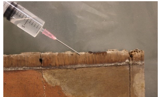
Figura 32 Consolidação do suporte lenhoso por injeção com Paraloid® B72 em Shellsol® A na borda superior de uma das pranchas
