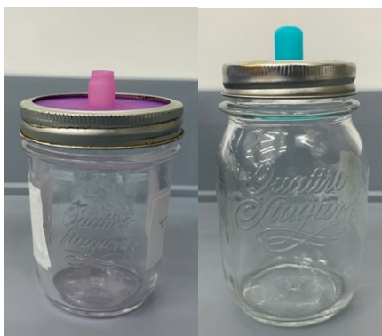
Figura 3.1. Imagem dos frascos de 320g (à direita) e 520g (à esquerda) e respectivos airlocks de silicone utilizados nas fermentações de purga de ketchup.
