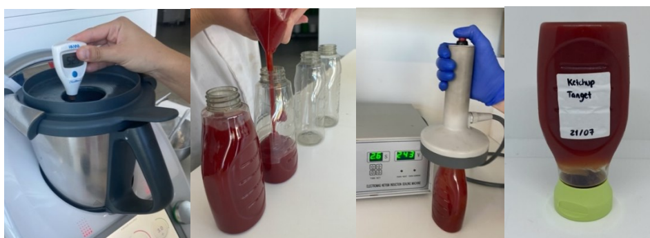
Figura 3.2. Etapas do desenvolvimento do ketchup: produção, enchimento, rotulagem e selagem, respetivamente.
