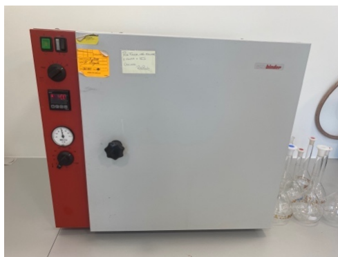
Figura 5. Câmara de secagem e aquecimento B53
