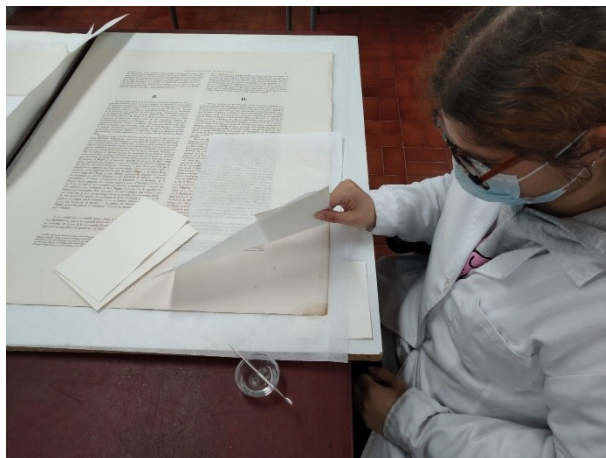
Apêndice M - 3 Absorção da humidade da pasta de papel. ©Manuel Sousa BPMP
