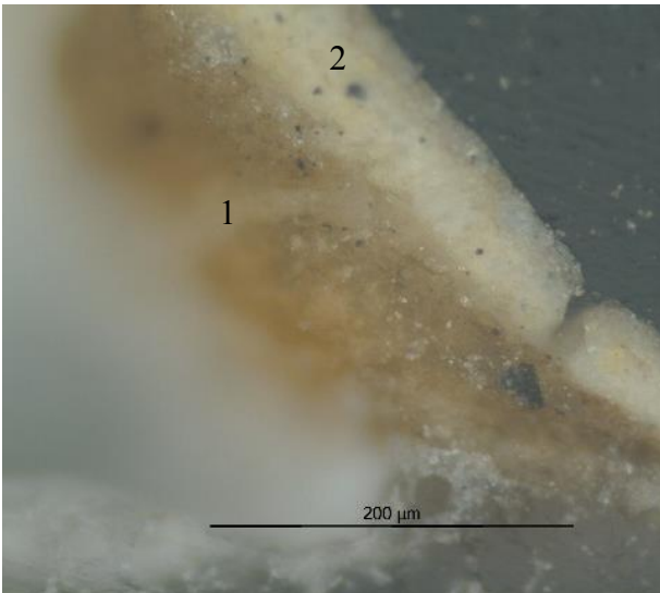
Fig.AIII. 14 - Corte estratigráfico da amostra A4 (MO, ampliação de 20X); Amarelo esverdeado; Gibão da figura do lado direito, da perspectiva do observador.
