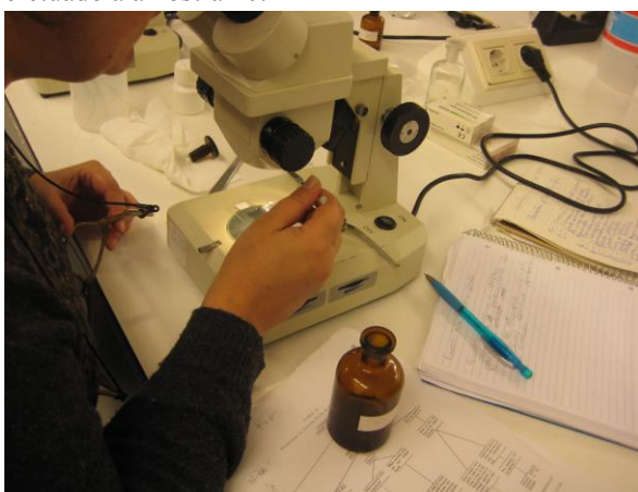
Fig.AIII. 32 – Pormenor da adição de iodeto de potássio na segunda fase do teste microquímico efetuado à amostra 10.
