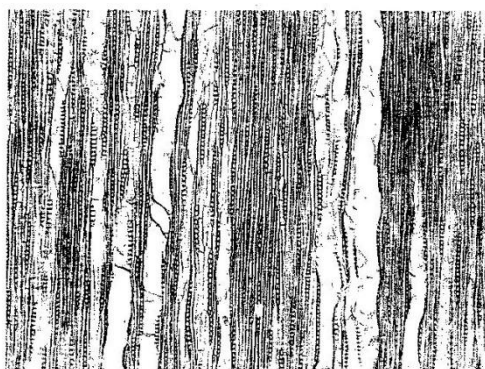
Fig.AIII. 3 - Microfotografias dos planos de corte de uma madeira de castanho ( Castanea Sativa Mill. ).
