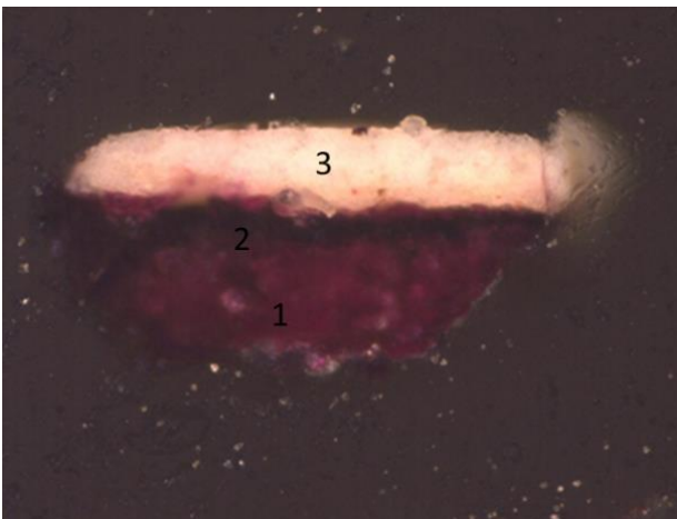
Fig.AIII. 29 - Corte estratigráfico da amostra A10 (MO, ampliação de 20X); Branco; Cendal.
