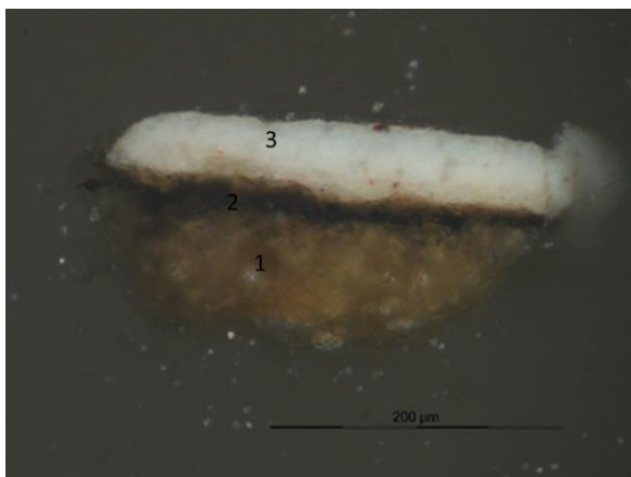
Fig. 3 – Corte estratigráfico da amostra 10, do branco do cendal. MO luz refletida (ampliação 200x).
