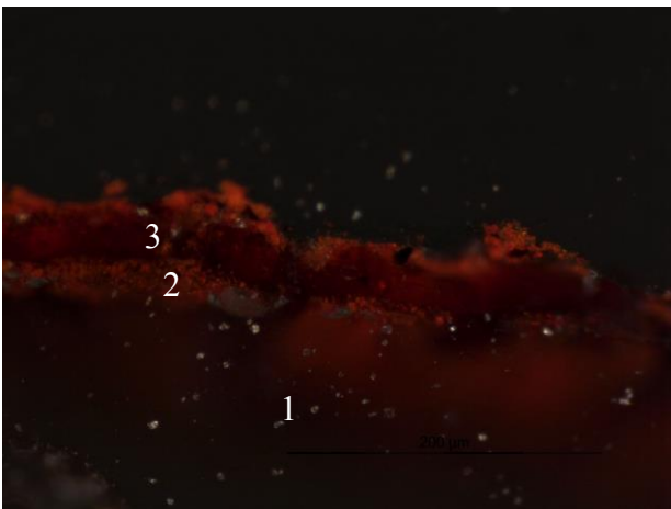
Fig.AIII. 19 - Corte estratigráfico da amostra A6 (MO, ampliação de 20X); Vermelho-escuro; Gibão da figura do lado esquerdo, da perspectiva do observador.
