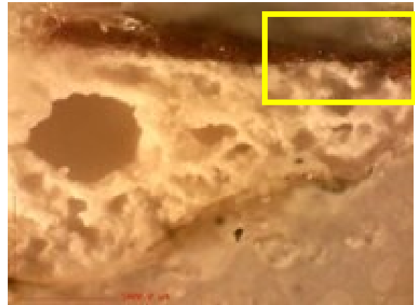
Figura An- I 10- Local de análise por EDS da amostra Am1S2. Corte estratigráfico da amostra Am1.
