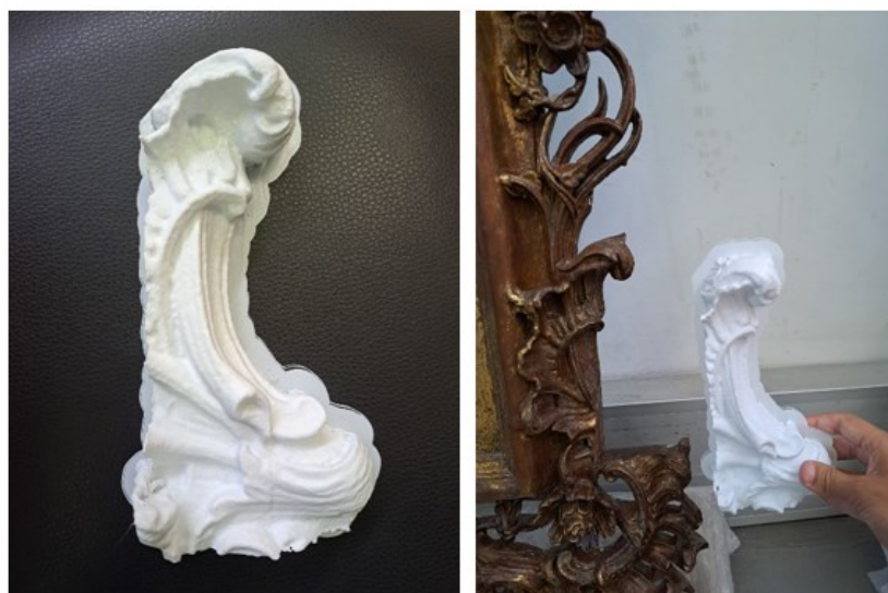
Fig. 24 – (1) Peça impressa em 3D. (2) Peça impressa em 3D em comparação com moldura 2. Mafalda Noverça© 2022
