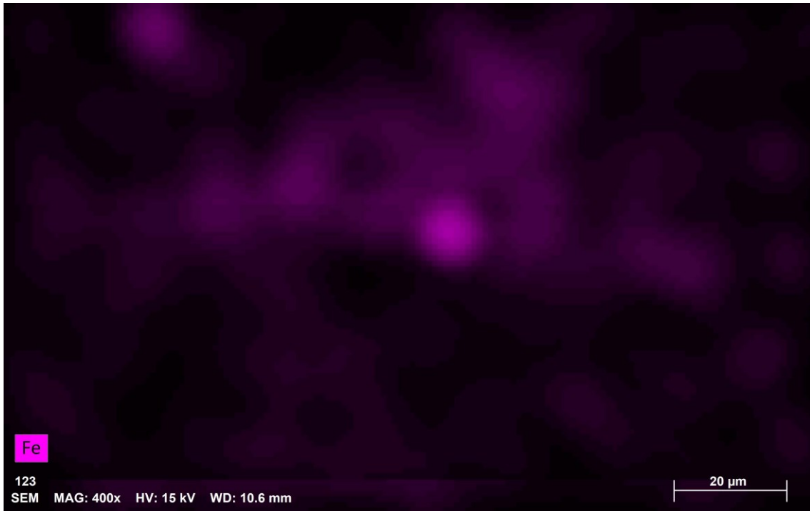
Figura An- I 14- Mapa de EDS da amostra Am1S2 (Fe).
