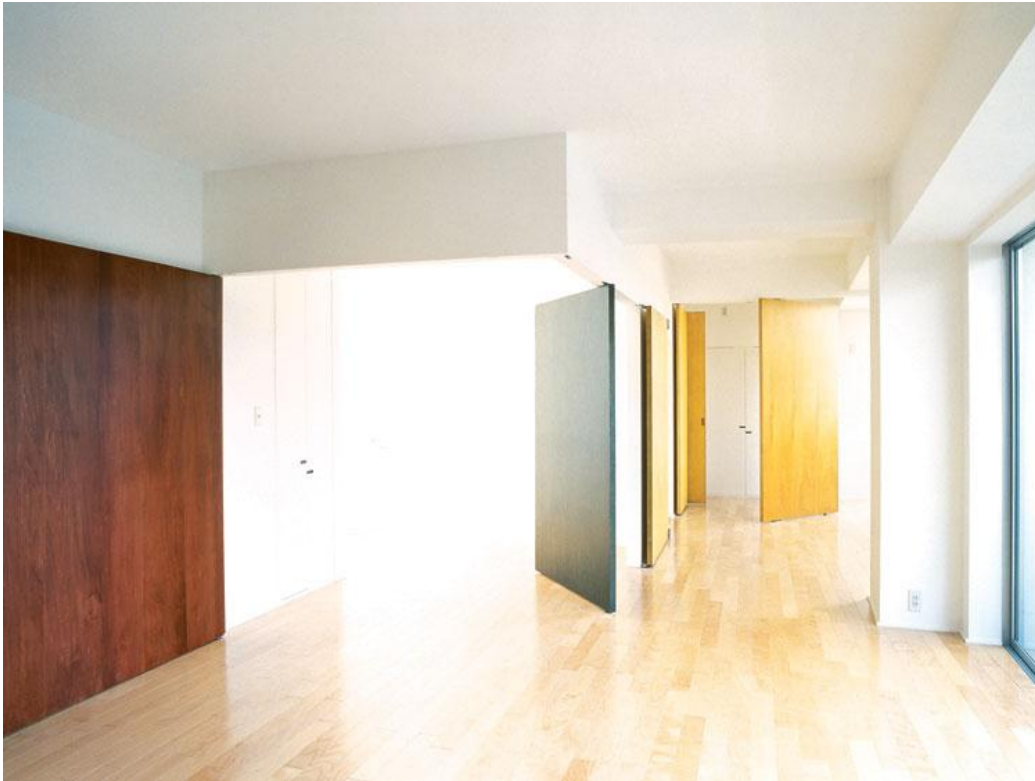
Fig.12-Perspectiva Interior dos apartamentos de Fukuoka, onde podemos observar a flexibilidade do espaço gerada através de painéis rotativos.
