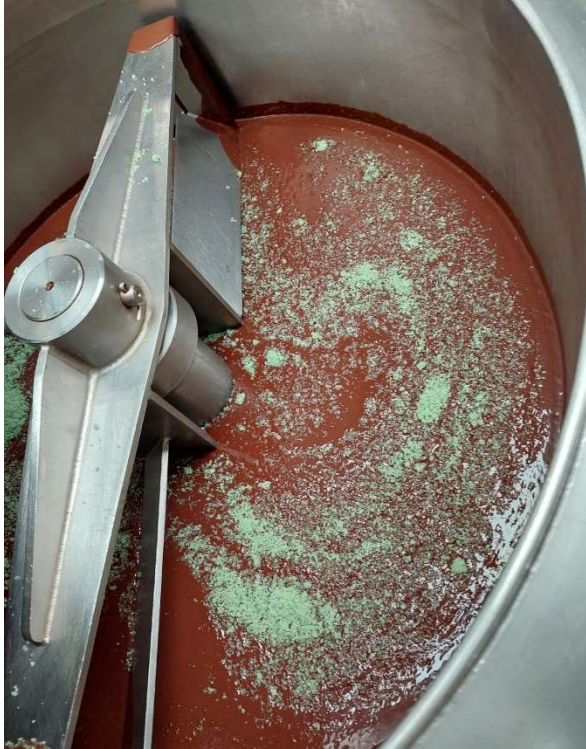
Figura 11 - Mistura das pepitas de lima na massa de chocolate preto, durante o processo de produção do produto (teste industrial).
