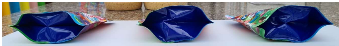
Figura 27 - Análise comparativa das amostras obtidas no embalamento de 130 g (esquerda), 140 g (meio) e 150 g (direita) do ensaio industrial.
