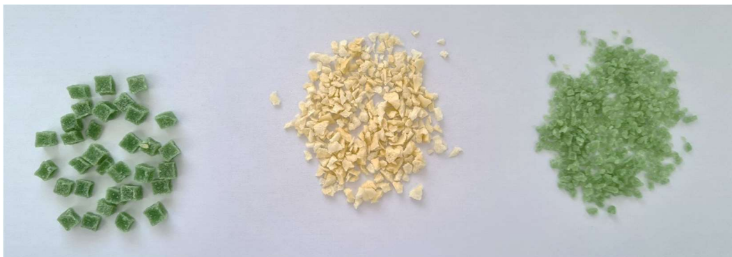
Figura 7 - Comparação visual entre as pepitas de lima atuais (esquerda) e as pepitas de lima alternativas (centro e direita).
