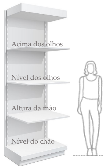
Figura 10 – Esquema de disposição e nivelção vertical de prateleiras.
