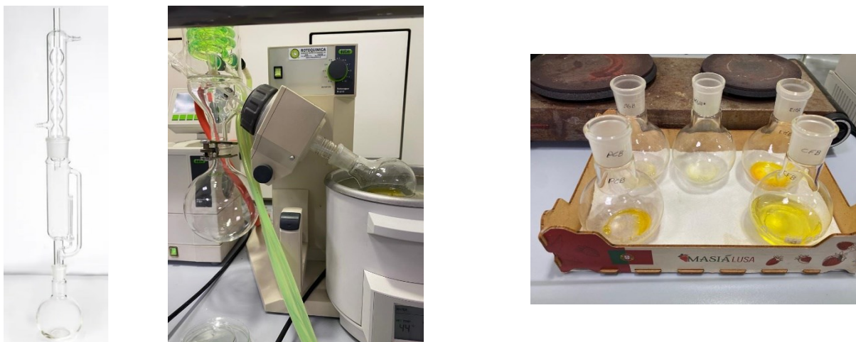
Figura 3.16. Montagem para extração Soxhlet (em baixo o balão de extração, no meio o Soxhlet e em cima o condensador de arrefecimento (esquerda), evaporação o solvente num hote a vapor (centro) e balões de extração antes e depois da evaporação do solvente (direita)
