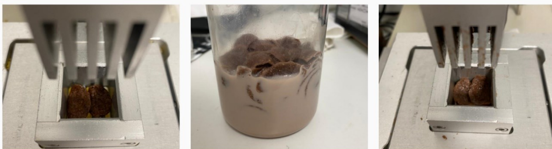
Figura 3.10. . Medição de textura sem imersão, cereais em imersão em leite, medição de textura com imersão, respetivamente da esquerda par a direita.
