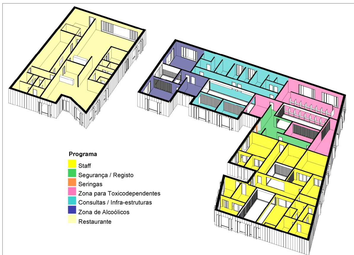
Fig. 57 – Axonometria explicativa do interior do edifício para Toxicodependentes e alcoólicos através de zonas.
