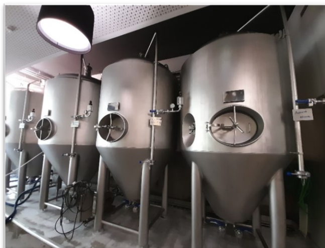
Figura 4 Tanques CCT (Tanques Cilíndrico-Cónicos) isotérmicos.
