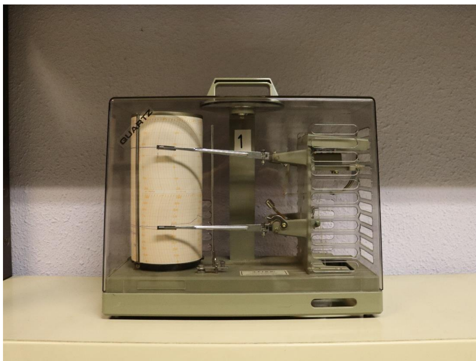
Fig. E8.11 – Termohigrógrafo utilizado para registar valores das condições ambientais (T em °C, e HR em %)no interior da reserva R1.
