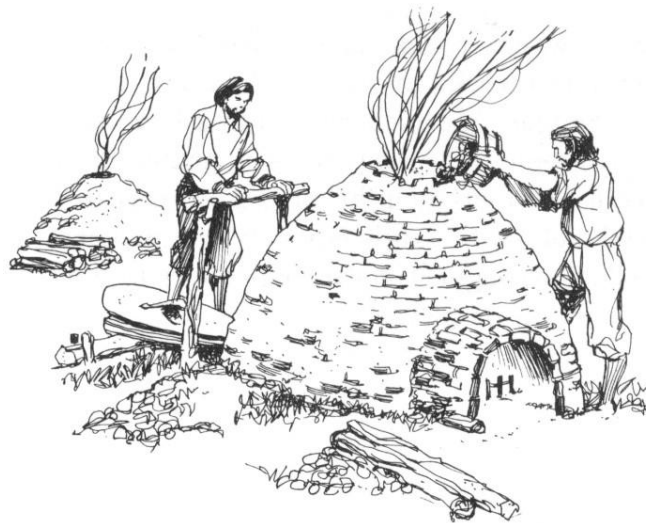
Fig. G1.31 – Um esboço conjectural, segundo Sidney King, de um forno de terra para fundir ferro, com fole acionado manualmente. Foram usados em Inglaterra no início do séc. XVII. Fonte: Ford, 2018.
