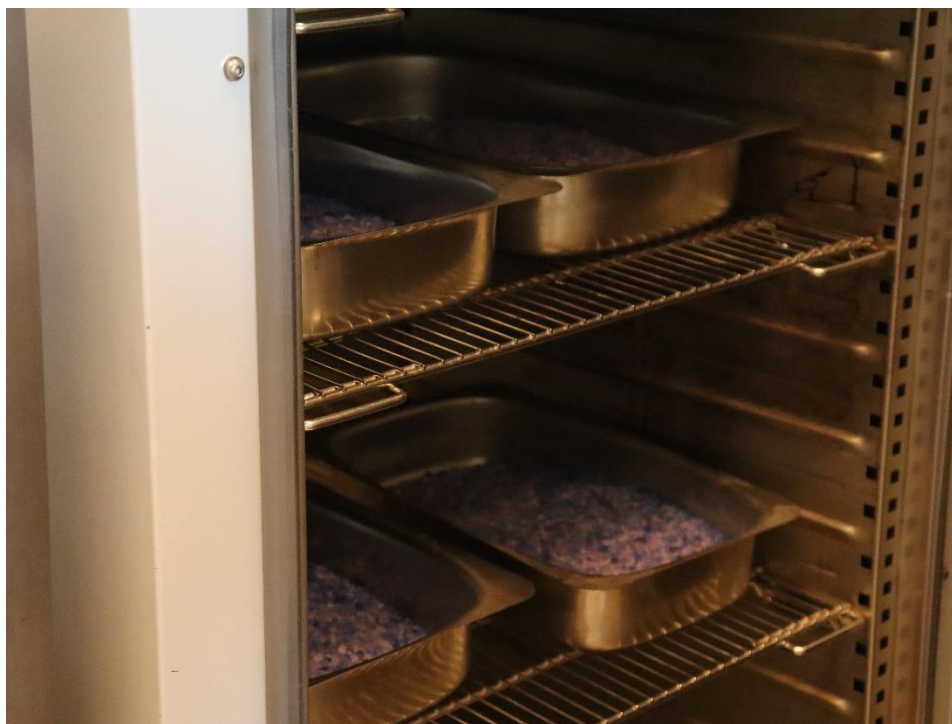
Fig. E8.10 – Tabuleiros de sílica-gel em processo de regeneração, no interior da mufla do LCR, a 60°C.
