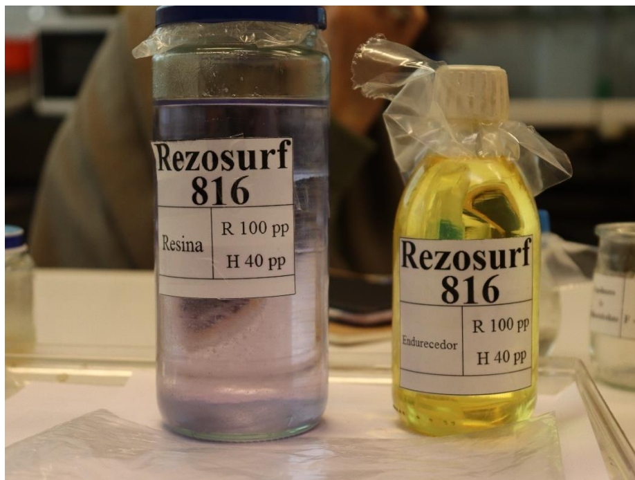
Fig. E5.1 – Epóxida bicomponente Rezofurf 816, utilizada no processo de reintegração volumétrica, aplicada na proporção de 100 partes de resina (R) para 40 partes de endurecedor (H).
