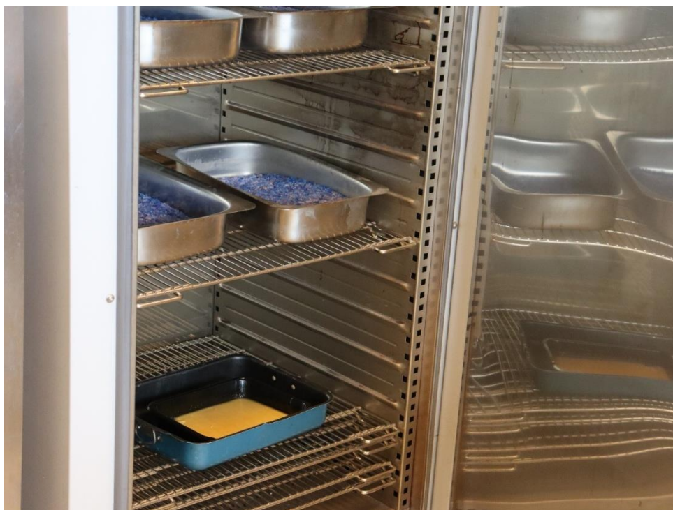
Fig. E6.3 – Aquecimento em mufla da proteção final (tabuleiro interior) em banho-maria (tabuleiro exterior).
