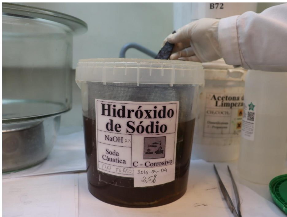
Fig. E3.1 – Imersão da Falcata na solução alcalina de água destilada e hidróxido de sódio (NaOH) a 2,5%.
