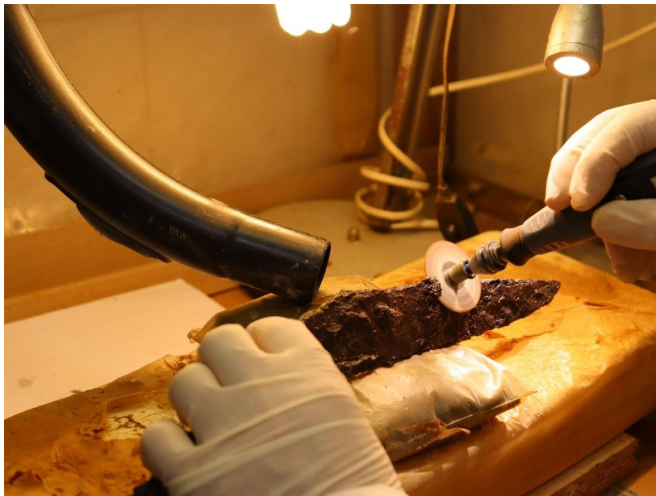
Fig. E2.1 – Limpeza mecânica da Falcata em liga de ferro do período Romano (nº de inventário 2024.0732), em ambiente controlado, apoiada num peso de areia, dentro de uma cabine vedada por vidro acrílico, fontes de iluminação móveis e sistema de extração de poeiras. Remoção localizada de conreções e bolsas de corrosão através da utilização de uma micro-retífica (Dremel Speedclic®) equipada com discos de corte diamantados.
