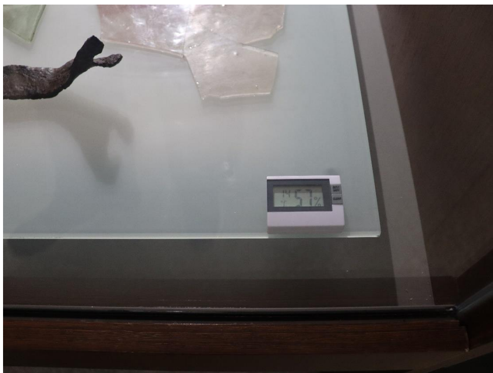
Fig. E7.9 – Fotografia de pormenor do termohigrómetro que regista os valores de 14 °C de T e 57% de HR, na vitrine nº 3.02, que acondiciona artefactos em ligas de ferro e artefactos vítreos.
