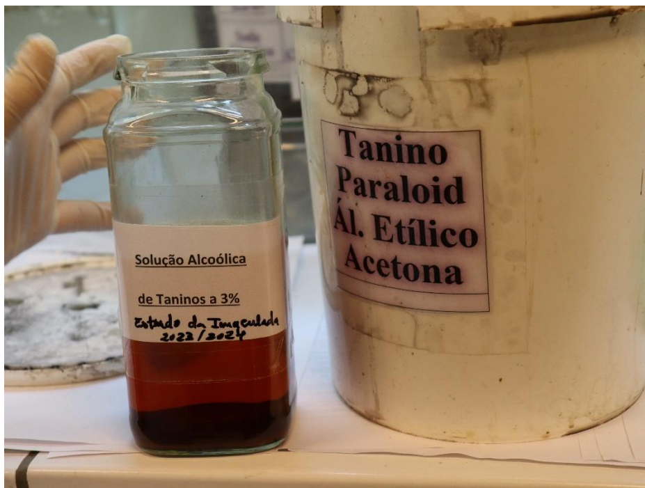
Fig. E4.1 – Produtos utilizados no processo de consolidação interna e inibição da corrosão: solução de Paraloid® B72 – entre 6% e 10% dissolvido em acetona; e solução de taninos (geralmente ácido tânico), entre 2,5% e 3%, dissolvido em álcool etílico absoluto (à esquerda). Estas soluções são misturadas, dando origem à solução final utilizada neste tratamento (à direita).
