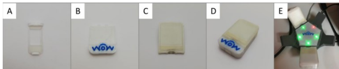
Figura 22. Componentes da WoW Box e estação de carregamento de baterias: (A) parte traseira; (B) parte central que contém a placa de circuito impresso; (C) bateria, parte superior; (D) WoW Box montada; (E) estação de carregamento das baterias.
