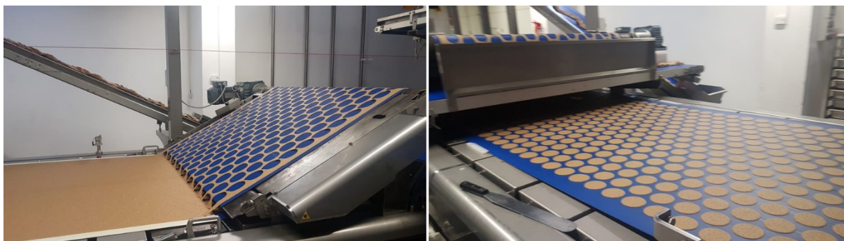
Figura 1.12 – Fotografias reais do cilindro de impressão e corte: à esquerda o retalho originado e à direita a formação das 16 filas de bolacha Integral .
