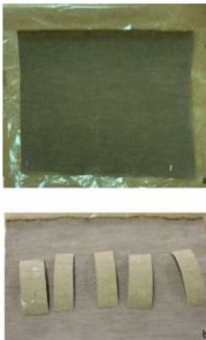
Figura 35 - Tela de poliéster impermeabilizada (a); provetes para realização dos testes (b).
