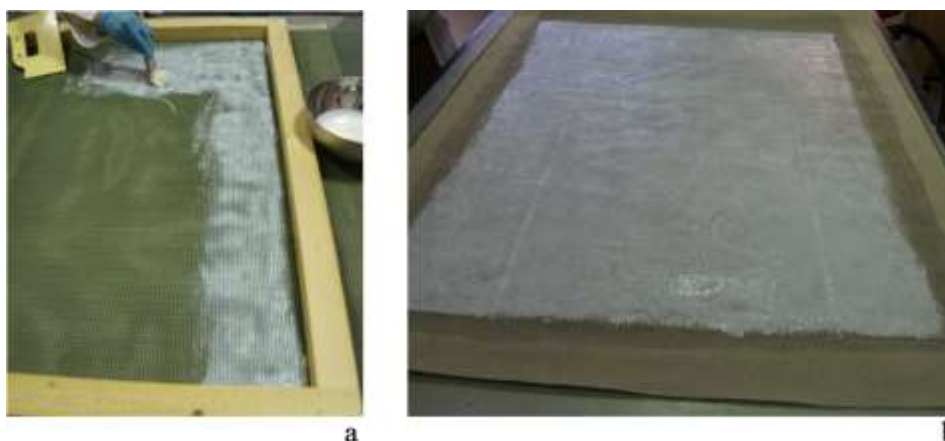
Figura 38 - Metodologia de entretelagem: aplicação do Plextol® com o éter de celulose (20:80) sobre a rede para fim de nap-bond (a); adesivo aplicado através de técnica de nap-bond sobre o suporte de Poliéster (b).
