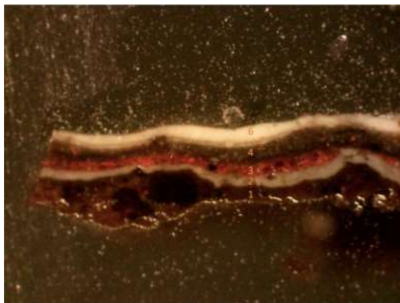
Figura 24 - Visualização por MO das camadas de preparação do corte estratigráfico da amostra A19.
