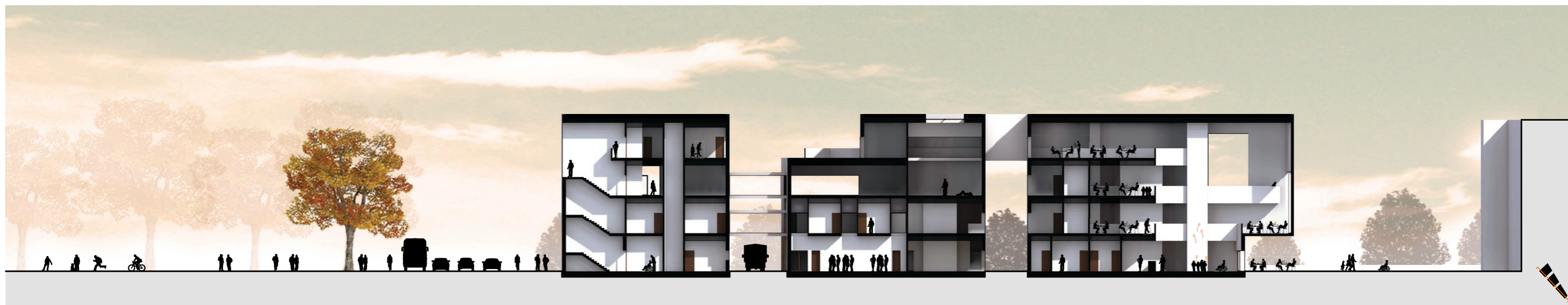
Fig.53 Corte longitudinal ilustrativo do acesso ao programa dos últimos pisos, dos espaços polivalentes, de ginásio e de restaurante. Ilustra ainda a relação do conjunto edificado com as duas praças que lhe ladeiam. Fonte Elaboração própria.
