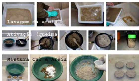
Figura 14 – Procedimentos de lavagem de areia (eliminação de impurezas e contaminações orgânicas), de ativação (queima) e de testes de traços de argamassas para revestimentos especiais. Fonte: CECI
