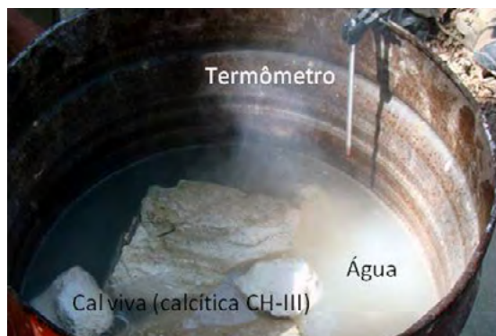
Figura 13 – Extinção da cal calcítica CH-III para hidratação e maturação durante três ou mais anos. O processo exotérmico deve apresentar temperaturas entre 95Co e 100Co. Fonte: CECI
