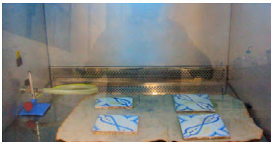
Figura 15 – Foram aplicados vários testes de aceleração de envelhecimento, dentre eles incidência de UV. O horizonte nesta câmara foi de 43 anos para manifestação de deterioração no enxerto (vide imagem ao lado). Fonte: CECI/2010.
