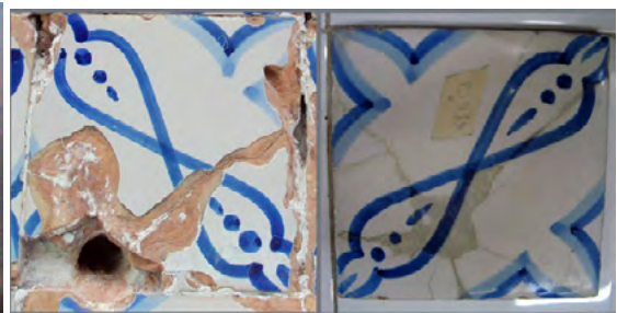
Figura 16 – Exemplos de um dos tipos de danos nos azulejos e do resultado dos testes de aceleração de envelhecimento em laboratório. Fonte: CECI/2010.
