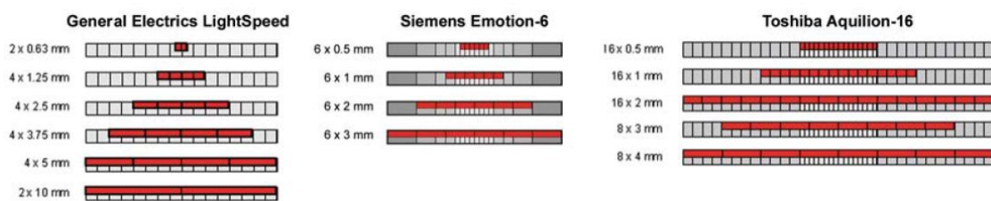
Figura 7.4 - Possibilidades de combinações de vários detectores, predefinidas pelos fabricantes para estes modelos de equipamentos, para posterior reconstrução da espessura de corte pretendida. Exemplos de um equipamento de TC de matriz de 4 cortes (GE LightSpeed), de um equipamento de TC de matriz adaptativa de 6 cortes (Siemens Emotion-6), e de um equipamento de TC de matriz híbrida de 16 cortes (Toshiba Aquilion-16) (fonte: MARCHAL, 2005)
