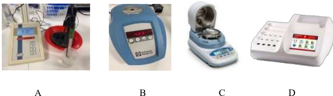
Figura 3.3. - Equipamentos usados para a determinação dos diferentes parâmetros físico-químicos– (A) Potenciómetro; (B) Refratómetro; (C) Balança de determinação % humidade; (D) Espectrofotómetro.
