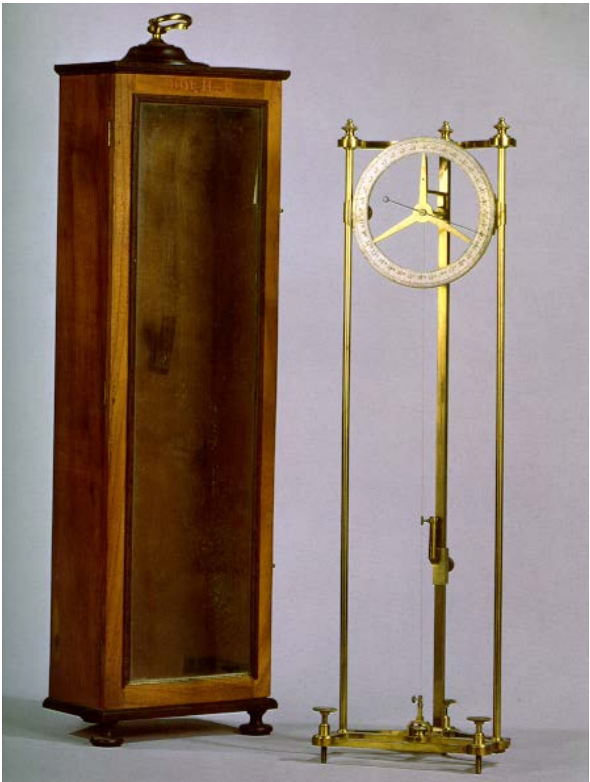
Figura 7 - Higrómetro de Saussure. Museu de Física da Universidade de Coimbra. CAT. 1824:L.II.108.
