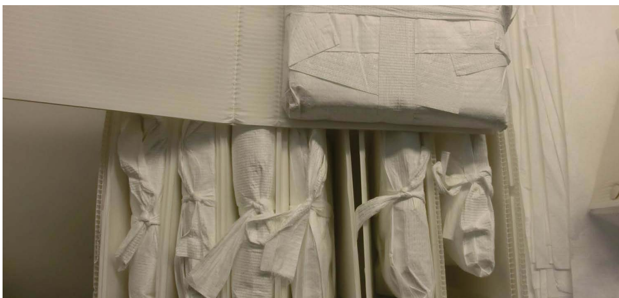
Figura 2 – Exemplo de uma embalagem onde os azulejos se encontram embalados individualmente em folha de tyvek® com suporte de polipropileno.
