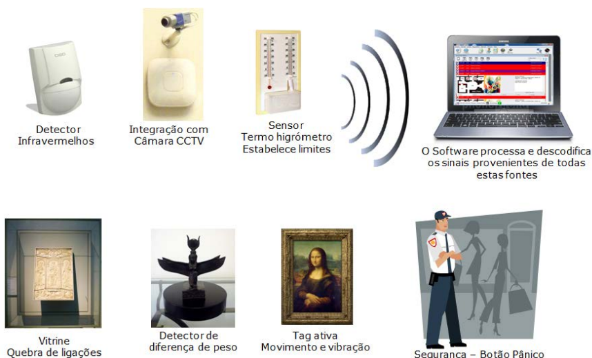
Figura 5 - Instalação típica de um sistema RFID com tags activas.
