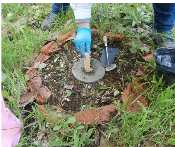
Figura 14 – Colocação de iscos de abeto, de produção nacional, em estação de localização inserida no solo em torno do AHU.
