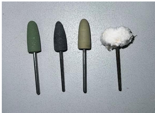
Figura 6 - Sequência das brocas de polimento
