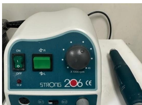
Figura 7 - Micromotor e peça de mão
