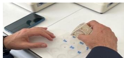
Figura 71- Colocação da resina preparada
