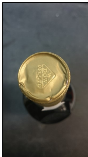
Figura 15 – Garrafa com chapéu na cápsula.
