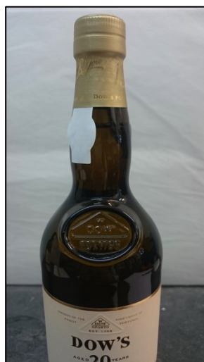
Figura 17 – Garrafa com o selo desalinhado.
