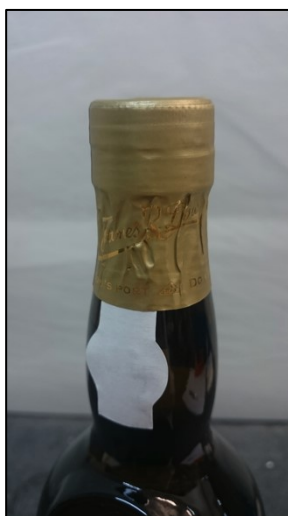
Figura 16 – Garrafa com rugas na cápsula.
