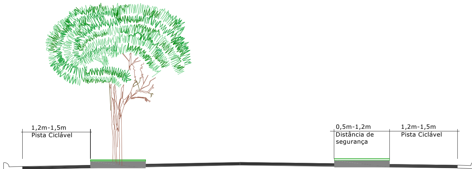
Figura 6.2 Perfil tipo com as dimensões recomendadas para as Pistas exclusivas e para as separações físicas
