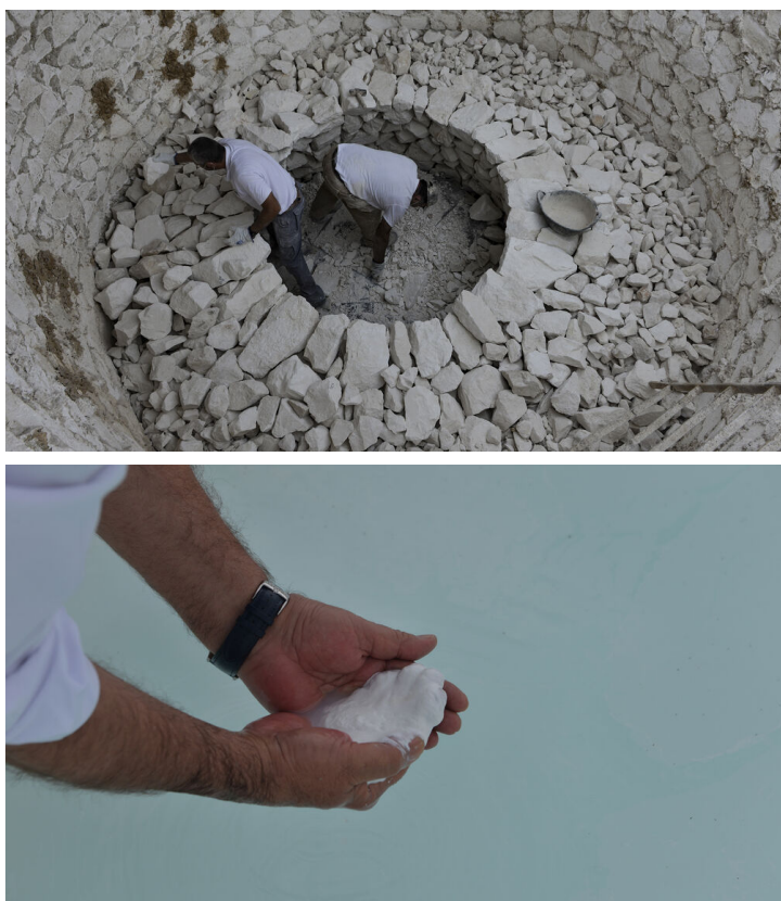
Figura 33 Así se fabrica la cal de Morón Fonte: © Diário de Sevilla. Disponível em: [ https://www.diariodesevilla.es/sevilla/asi-se-fabrica-cal-Moron_3_1567973198.html ]
